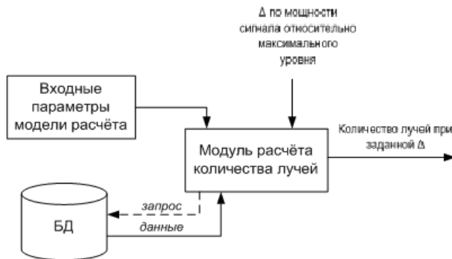
Рисунок 9. Структурная схема модуля расчета количества лучей
